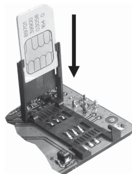
3. Вставить SIM-карту контактами в сторону открытой части разъёма как показано на рис.
